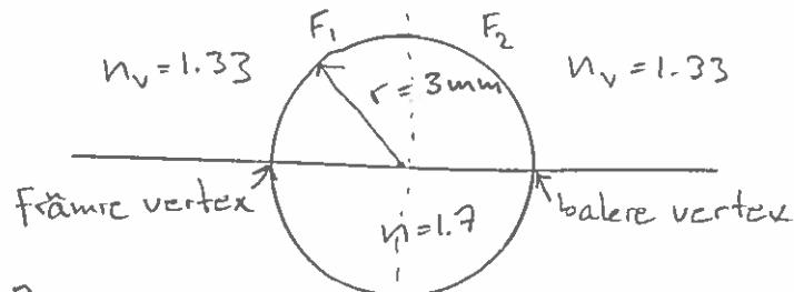
Eftersom det är samma brejdnings index på båda sidor av kulan sammantfaller nodalpunkterna med huvudplanen.
