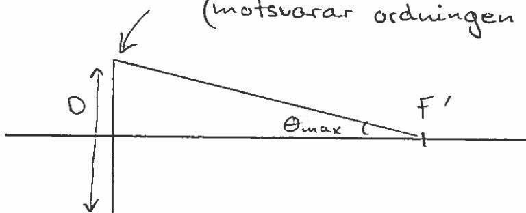
$$\text{Bländartalet ges av } \frac{f'}{D} = \frac{1}{2 \tan \theta_{\max}} = f^* \quad \left( \begin{array}{l} \text{får ur figur} \\ \text{med enkel geometri} \end{array} \right)$$
