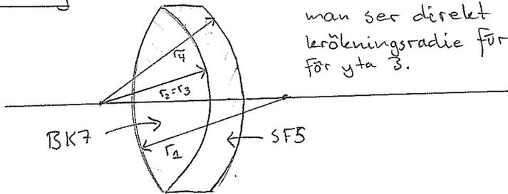
Cementerad lins ser ut som i figuren och man ser direkt att  $r_2 = r_3$ , dvs krökningsradie för yta 2 är samma som för yta 3.
