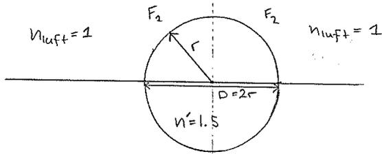
Nu måste  $f_E$  bestämmas! Eftersom kulan inte är en tunn lins måste beräkningar för tjocka linser användas (huvudplan osv...)
